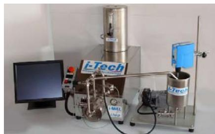
El molino de laboratorio i-Mill 0,5 ha sido construido con una cámara de molienda enteramente fabricada en Carburo de Silicio (CSi). Los discos de molienda han sido fabricados en un material especial que no se ve afectado por el desgaste por abrasión y es completamente compatible con las tintas inkjet. El molino presenta características casi idénticas a los molinos destinados para la producción de tintas, de este modo la simulación es mucho más aproximada y correcta.
