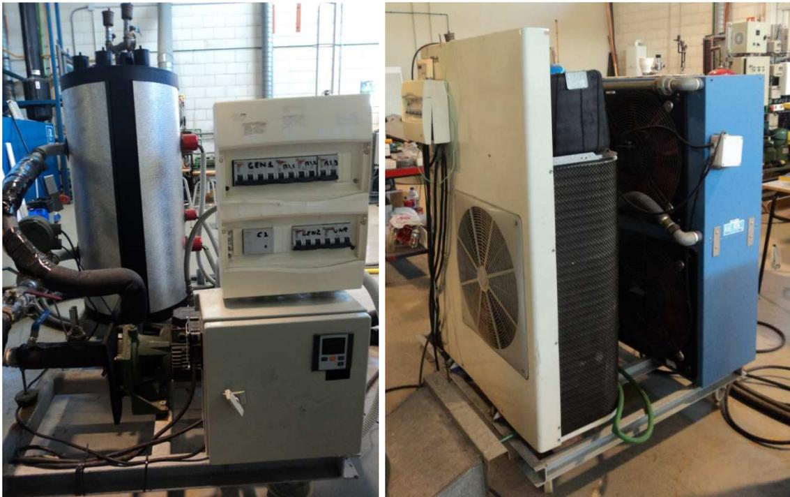
Figura 4.2. Circuito de simulación de carga y circuito de disipación.
