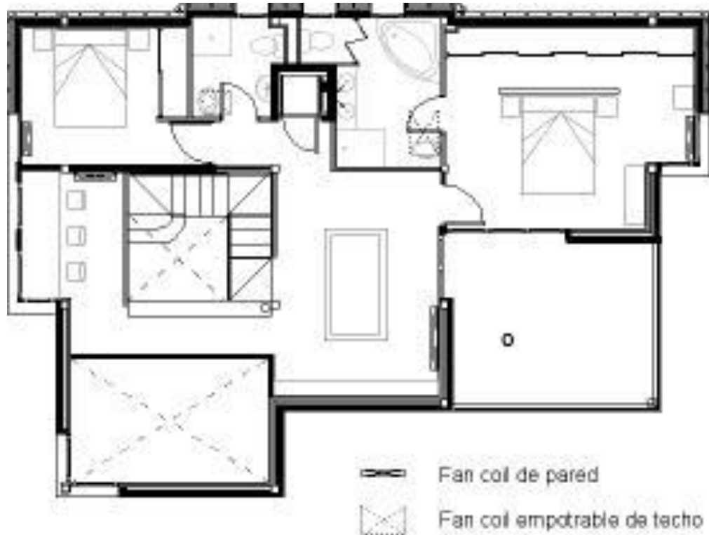
Situación de los fan coils en la Planta Segunda
