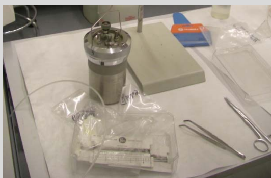
Figura 108: Bomba de oxígeno isoperibólica
