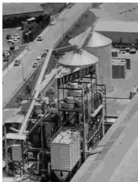
Se extrae de las minas con palas mecánicas, se concentra mediante varios métodos en mojado y si no, se procesa. Se gradúa a tamaños comerciales y se envía a plantas de exfoliación, donde se expande y luego se muele en forma de gránulos.
