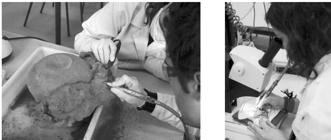
Figura 12.– 1. Limpieza mecánica de óxidos mediante vibroincisor y ultrasonidos. 2. Eliminación de óxidos de hierro bajo lupa binocular.
