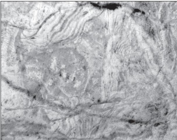
Figura 5. Torre de la Sal "b" (x 100). Fase de hidróxido de hierro producida por la corrosión total del hierro metálico.
