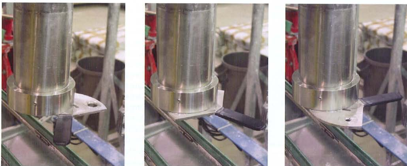
Figura 3. Detalle del sistema de cambio rápido de boquillas en sus tres posiciones (de izquierda a derecha) boquilla 1, cerrado y boquilla 2.
