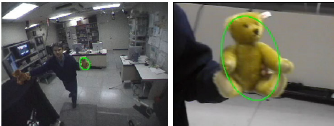
Figura 11.2. Reconocimiento y localización de objetos por segmentación en color a partir de información proporcionada a priori.
