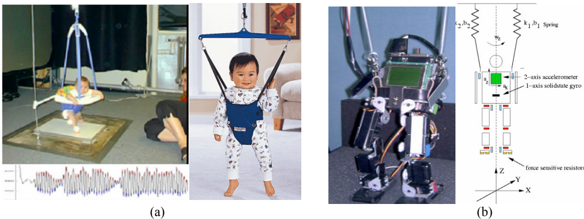
Figura 7.2. (a) Observación del comportamiento de niños colgados de resortes. (b) Robot que rebota.
