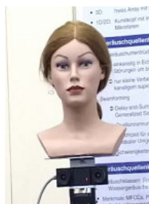
Figura 10.1. Interfaz robótica que gira la cabeza hacia la persona que le está hablando, pudiendo seguir el sonido de su voz y su cara.
