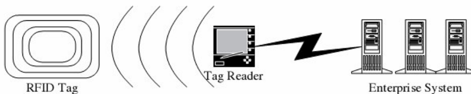
Figura 1.2. Comunicación de etiquetas RFID con lectores y sistemas informáticos [Roberts, 2006].
