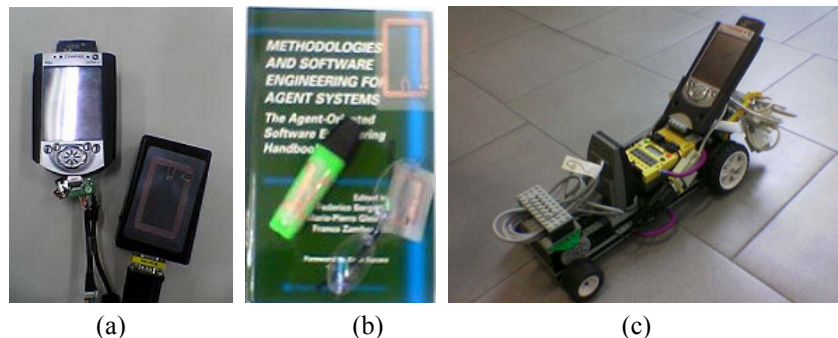
Figura 2.3.1. (a) Emisor y receptor RFID; (b) objetos con etiquetas RFID y (c) robot Lego construido para la búsqueda de los objetos etiquetados [Mamei & Zambonelli, 2005].
