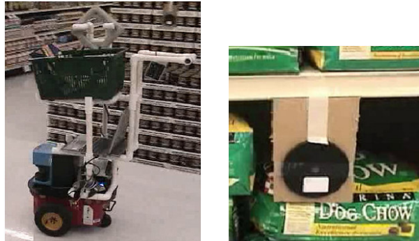
Figura 2.2.1. RoboCart y sensor RFID colocado en la estantería del supermercado [Kulyukin et al., 2005].
