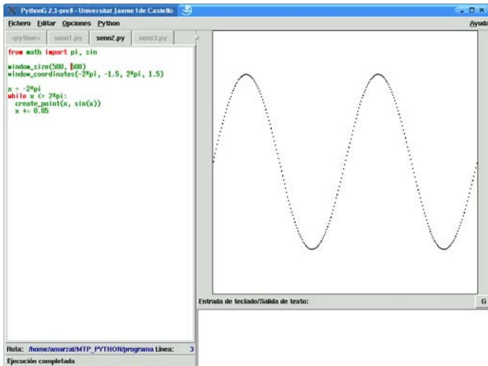
Figura 4.5: La función seno trazada con varios puntos.
