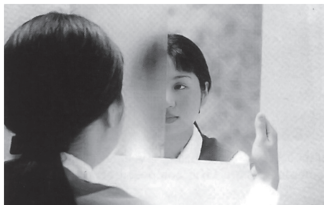
Figura 2. Efeito anticondensação de um revestimento fotocatalítico.
