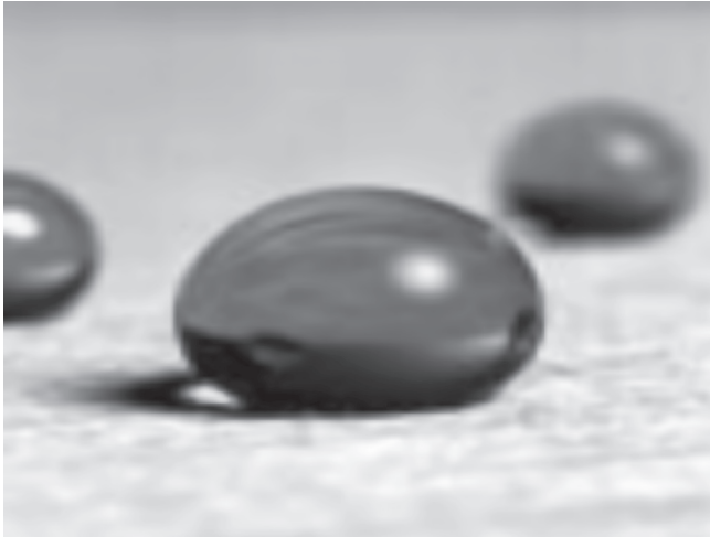
Figura 4. Formação de gota sobre uma superfície hidrofóbica.
