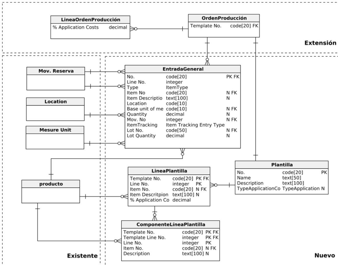
Figura 4.2: Diseño físico de la base de datos del proyecto.
