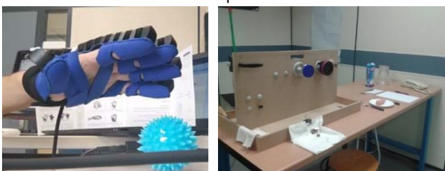
Figura 1: Izda: ExM de la marca EMFOCU utilizado en el experimento. Dcha: escenario para el test de Sollerman
