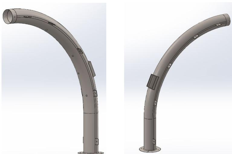
Figura 36: Tubo circular medio de unión (1.1.5)
