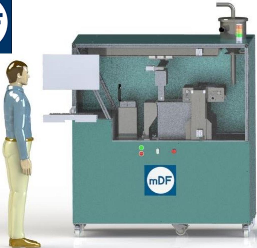
*Diseño de una Impresora 3D tipo “Inyección de aglutinante”*
