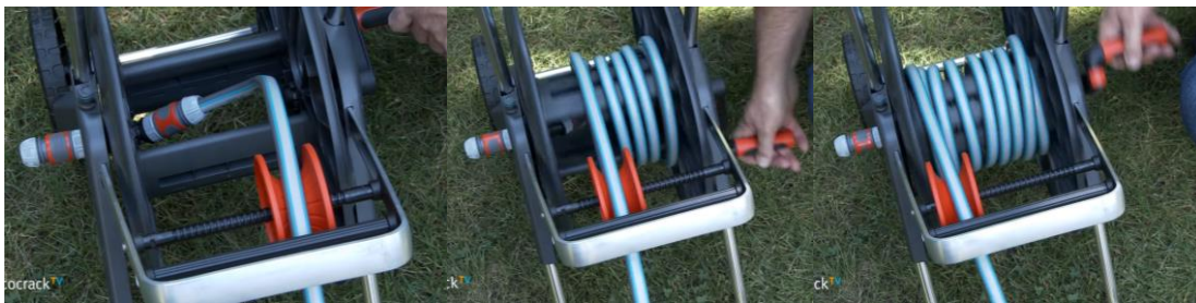
Figura 70: Ejemplo de mecanismo de guiado de manguera
