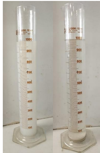
Figura 2.8. Ensayo de decantación. Agua residual (probeta izquierda) y agua decantada (probeta derecha)
