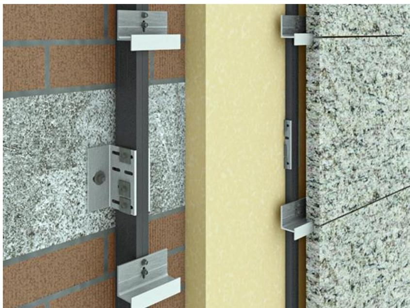
Imagen 12. Ejemplo gráfico de fachada ventilada. (Strow.es)
