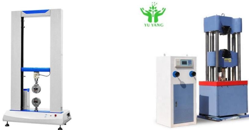
Imagen 23. Máquinas de ensayo universal, con 2 y 4 bastidores. (Web Ali Baba)
