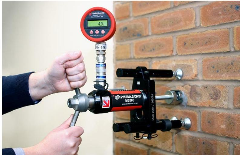
Imagen 7. Dinamómetro M2000 PRO Tester. (Hidrajaws.com)
