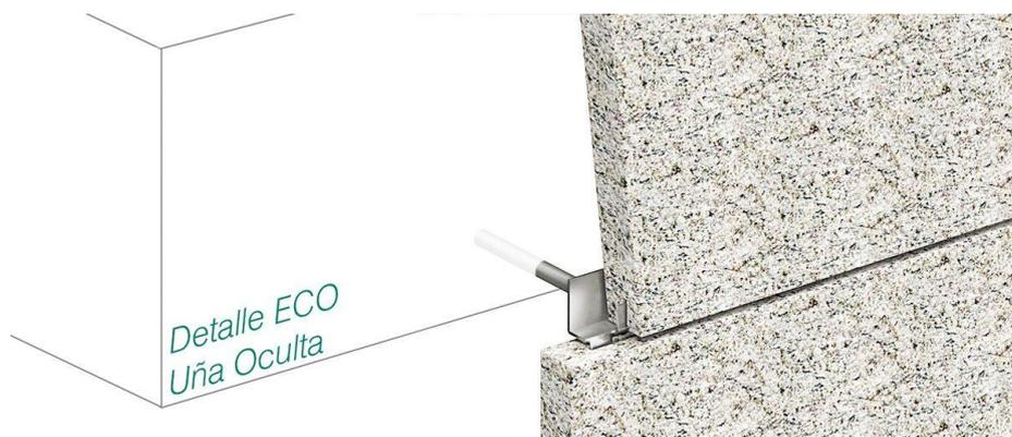
Imagen 14. Ejemplo de fijación mediante anclaje puntual. (Strow.es)
