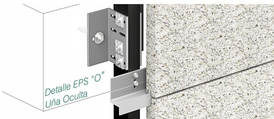
Imagen 15. Ejemplo de fijación mediante perfilería. (Strow.es)
