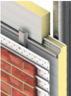
Imagen 103. Sistema Kingspan con acabado de ladrillo visto. (Estudio UPM)
