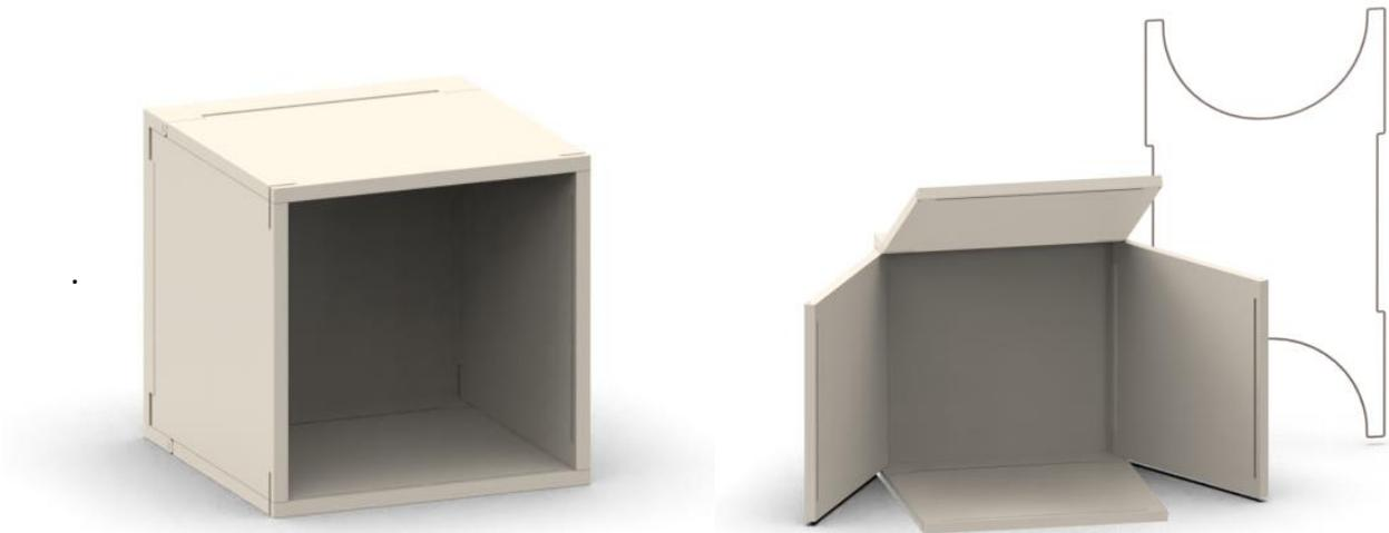
Ilustraciones 17 y 18. Propuesta 3 y sistema de fijación con cuerda
