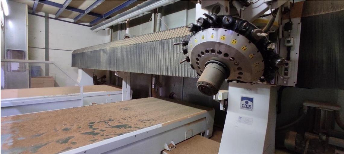
*Ilustración 90. Router CNC de 5 ejes de Hertalla*
