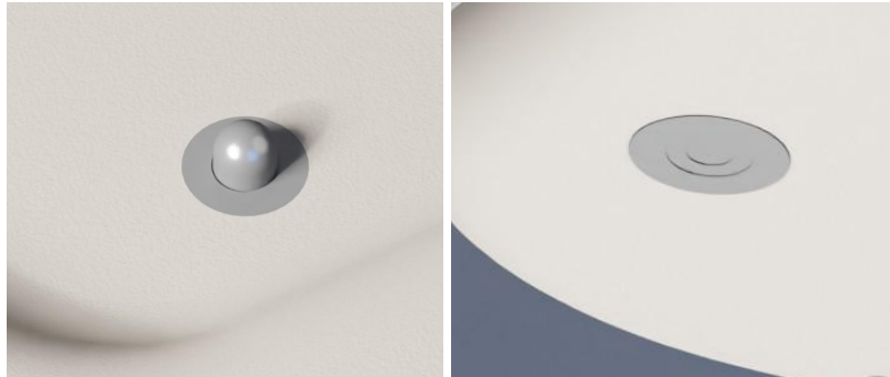
Figura 41. Pines pogo macho (base) y hembra (módulo).
