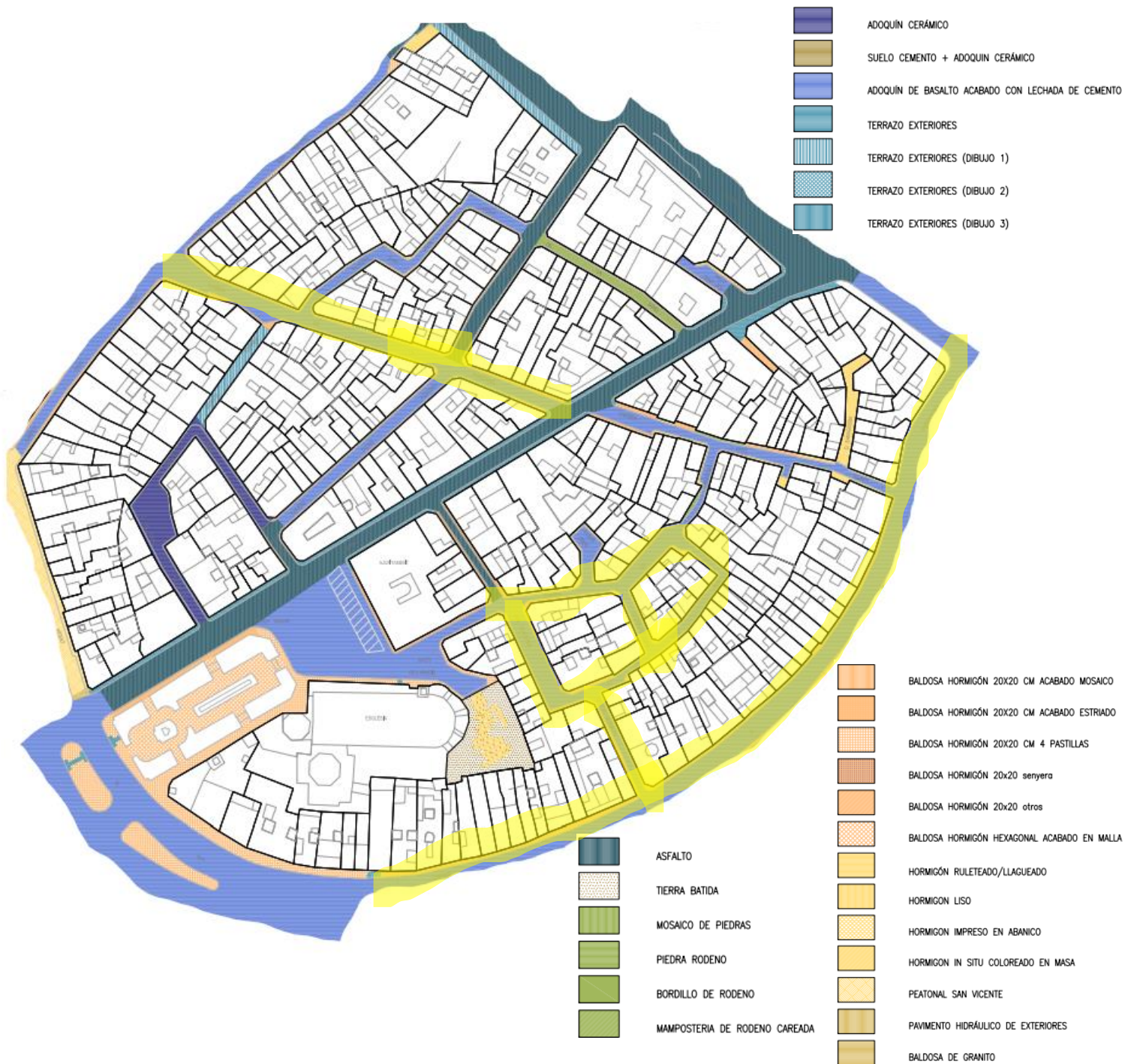
Plano urbanístico 12/ Plano de Tipos de Pavimento/ Ayuntamiento de Burriana
