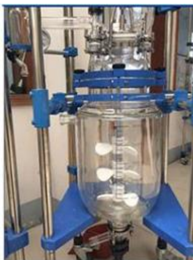
Figura A.7.1: Reactor RCTA de vidrio.
