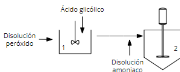
Figura A.6.1: Diagrama zona de alimentación de reactivos líquidos.
