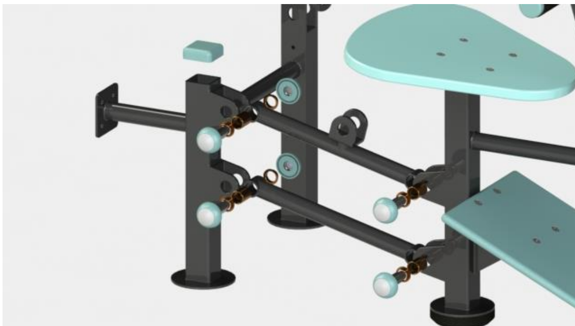
Ilustración 53: Montaje balancines a estructuras.
