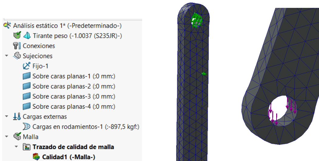
Ilustración 9: Condiciones iniciales análisis estático tirante.
