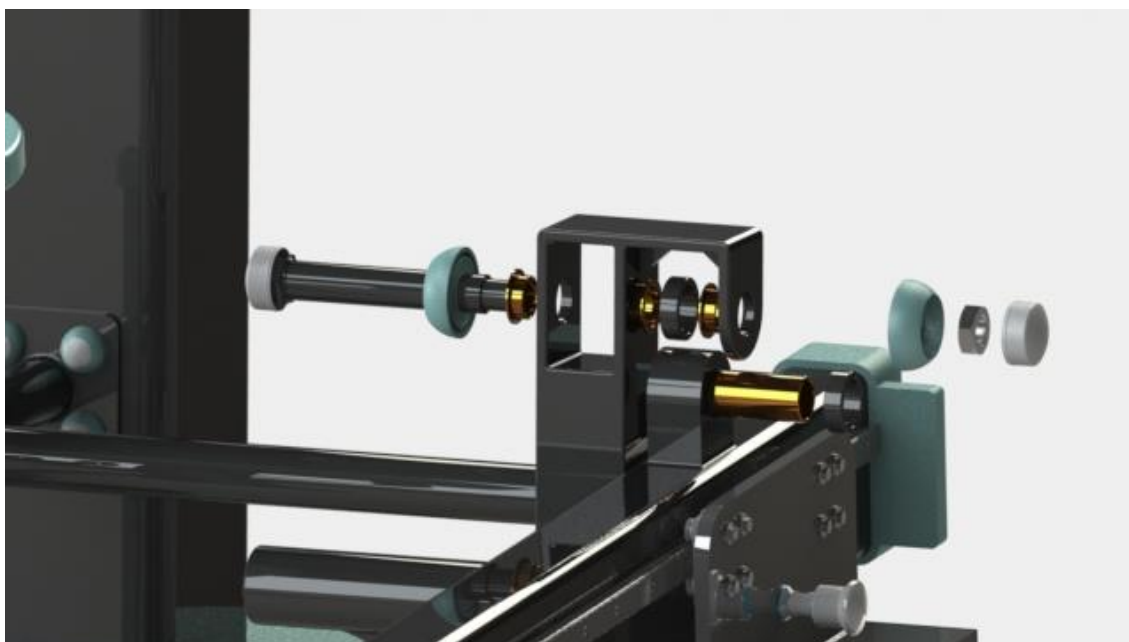
Ilustración 55: Montaje conjunto barra balancín a estructura.
