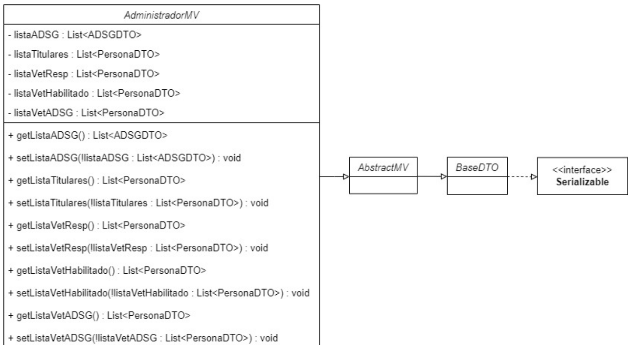
Figura A.29: Diagrama de clases del DTO MV AdministradorMV .
