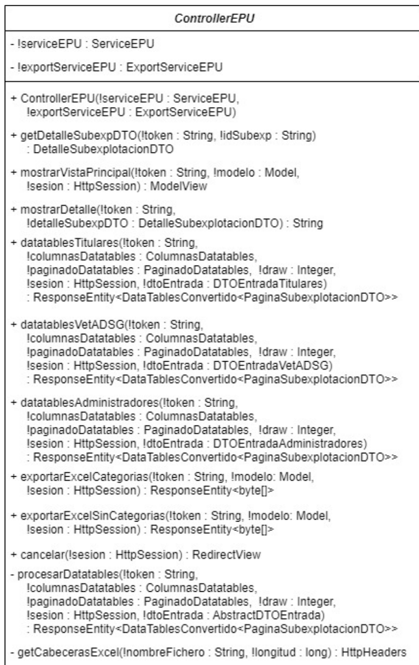
Figura B.7: Diagrama de clases de la clase ControllerEPU .
