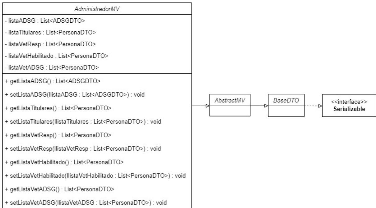
Figura 5.11: Diagrama de clases del DTO MV AdministradorMV .
