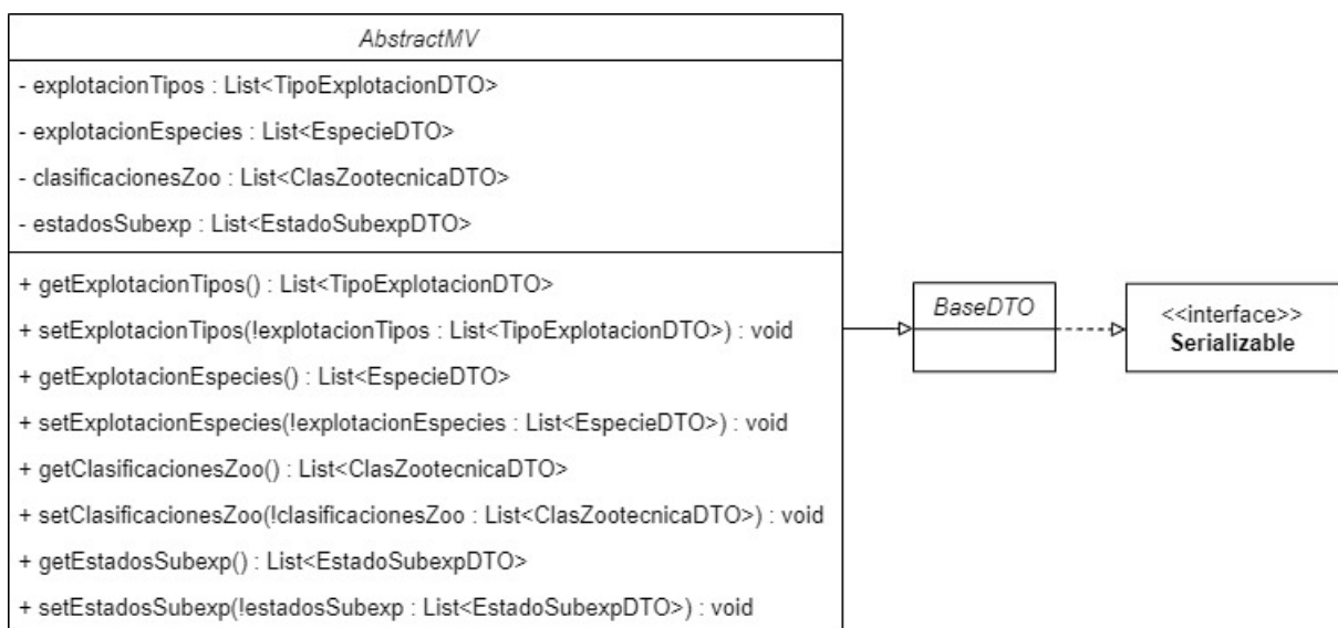
Figura A.26: Diagrama de clases del DTO MV AbstractMV .
