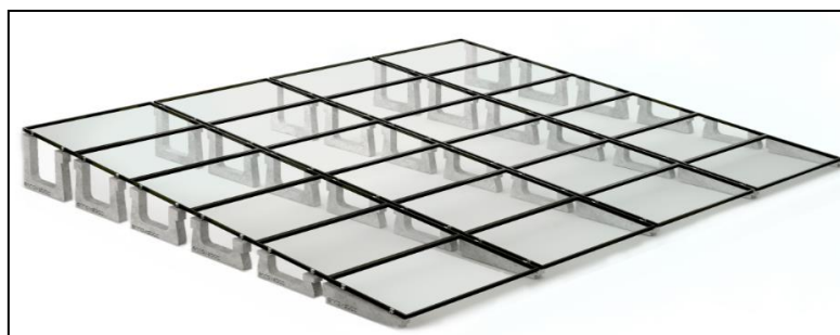
Figura 49. Disposició dels blocs de formigó per a distribuir les plaques en la quarta distribució plantejada. Font: [22].
