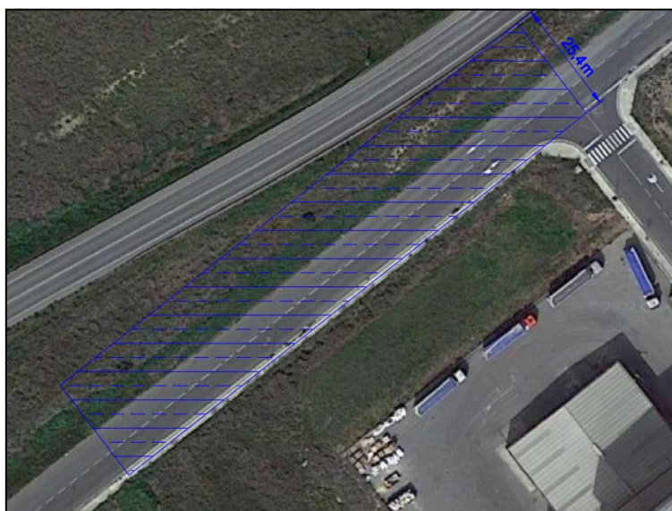
Figura 30. Distància mínima que hi ha entre la C-13 i les parcel·les on es realitzarà la instal·lació fotovoltaica. Font: Creació pròpia amb AutoCAD.
