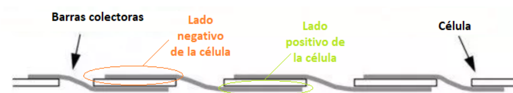
Figura 6. Connexions dels panells solars mitjançant les barres col·lectores. Font: [5] i Paint.
