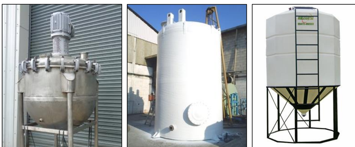
Figura 2.16. De izquierda a derecha: reactor con fondo semiesférico (Fuente: https://www.rigal-bennett.com ), reactor con fondo plano (Fuente: https://www.avanti.com.com ) y con fondo cónico. (Fuente: https://www.rotortanques.com )
