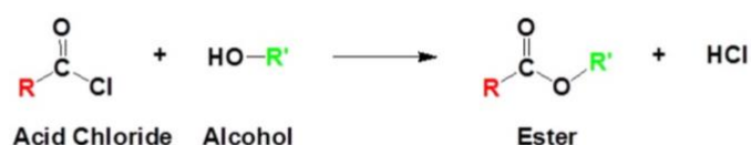
Figura 2. 1. Reacción entre el alcohol y un cloruro de ácido. Fuente: quimicasebas.blogspot.com
