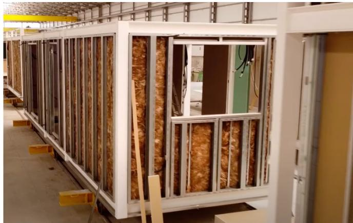
*Ilustración 77 Modulo siendo fabricado en serie.*
