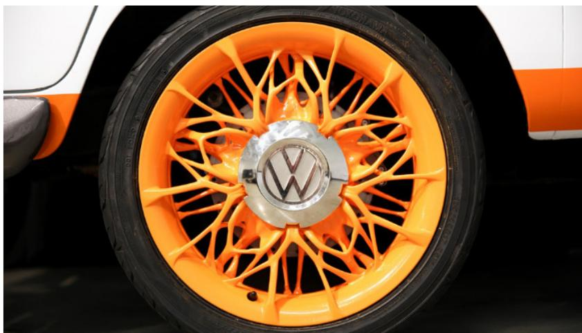
Ilustración 5. Diseño ruedas más ligeras de un microbús. Fuente: Volkswagen
