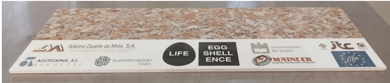
Figura 9. Baldosa de azulejo obtenida industrialmente con la composición con un 5% de bio-carbonato.
