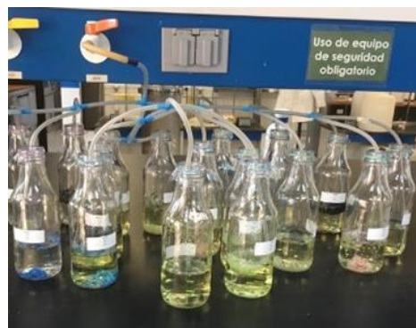
Figura 2. Montaje de los reactores para las pruebas de adsorción de cromo
