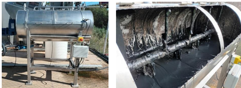
Figura 7: Fermentador en estado sólido ubicado de la planta piloto en la EDAR de Alcoy
