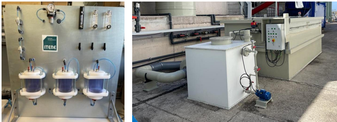
Figura 2: Prototipo biofiltro a escala laboratorio (izquierda) y a escala semi-industrial (derecha).
