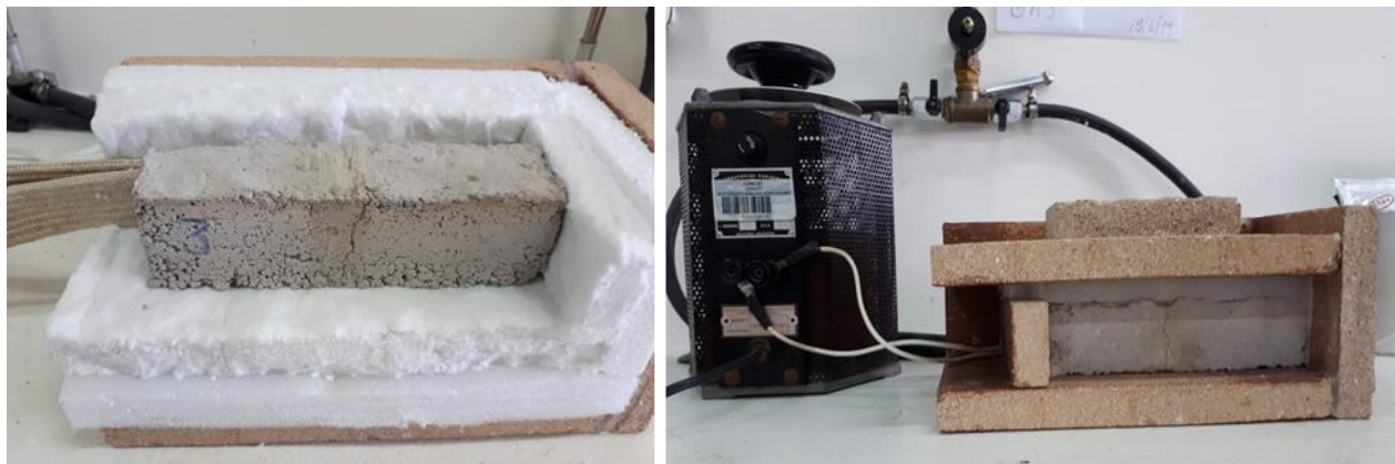
Figura 3: Equipo usado para medir la conductividad térmica. Adaptación del equipo bajo la Norma IRAM 11559:1995
