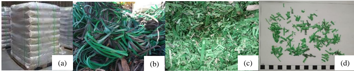
Figura 1: (a) Pallet con fleje PET, (b) residuo de fleje proveniente de bodega, (c) flejes PET triturado, (d) morfología del PET triturado
