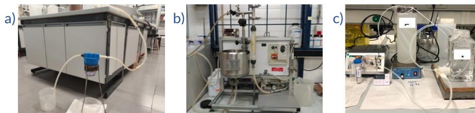
Figura 3: a) Filtración mediante cartuchos de diferente micraje; b) Planta de laboratorio de UF y c) Montaje experimental del contactor con membranas tubulares.
