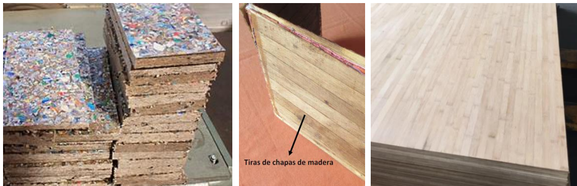
Figura 2. Muestra fotográfica de algunos de los tableros homogéneos y contrachapados en los cuales se sustenta la propuesta de fabricar, en Venezuela, los diferentes componentes de las bicicletas Coclowen a ser realizadas con materiales reciclados, entre otros, papel-plástico (Tetra Pak®), bambú y madera; en dimensiones comerciales con espesores desde los 3 mm hasta 15 mm y en modulación desde el los 1000 mm hasta los 3000 mm. Fotografías: Tetra Pak (2023); Contreras Miranda y Rondón (2016); Made in China (2023).
