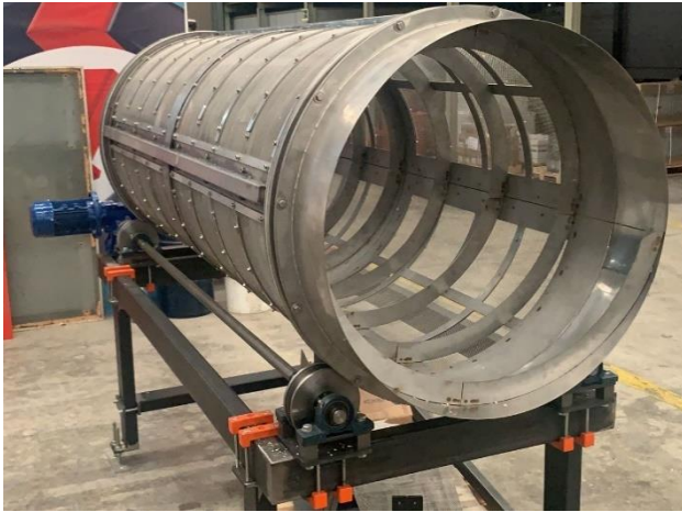
Figura 1. Tamiz rotatorio construido para la separación de la membrana.
