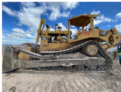
Figura 3. Bulldozer para la operación del frente de tiro de “La Escombrera” en León, México.
