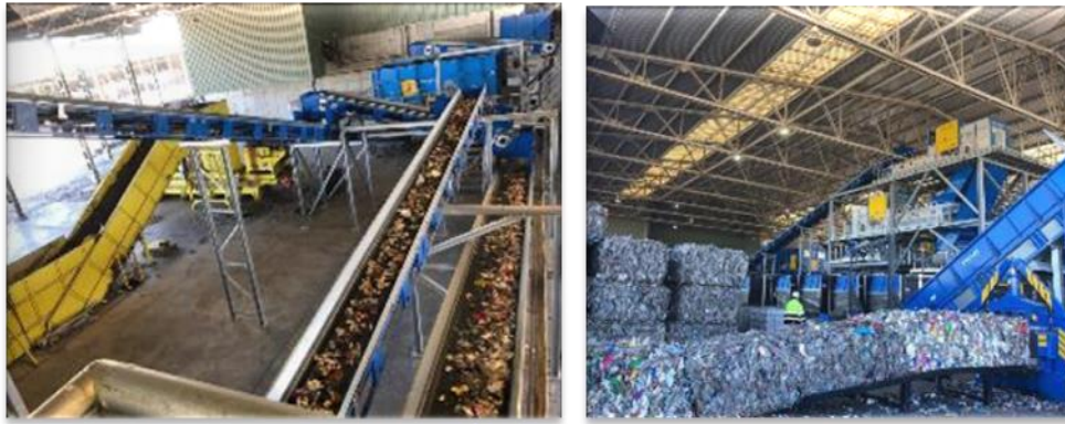
Figura 4. Imágenes de la etapa de separación de la planta del proyecto LIFE PLASMIX.
