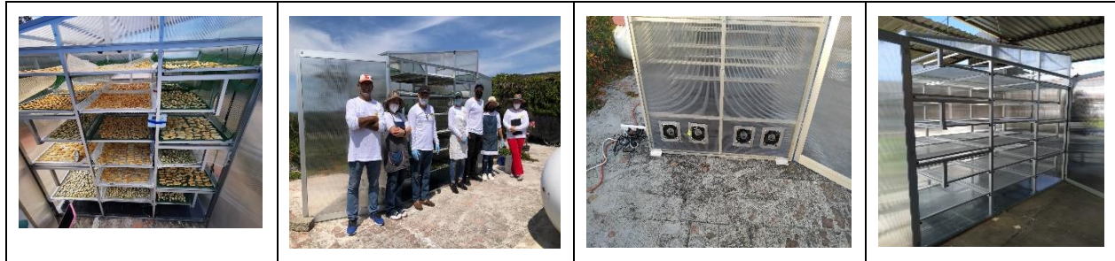
Figura 3. Imágenes del secador solar familiar uni-modular. i) vista general de los seis niveles de charolas, ii) dimensiones generales, iii) colocación de ventiladores en la parte inferior y iv) detalles de la manufactura.
