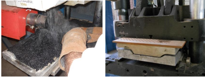
Figura 1. Colocación de la mezcla sobre matriz. Figura 2: Proceso de compactación.
