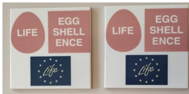
Figura 8. Baldosas de 15x15 cm de azulejo obtenidas con la composición estándar (izquierda) y con la composición con un 5% de bio-carbonato (derecha).
