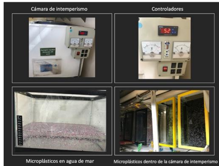
Figura 3. Realización del proceso de degradación en cámara de intemperismo acelerado.
