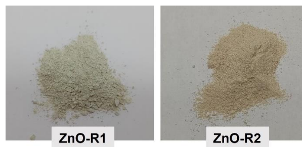
Figura 1. Aspecto de los óxidos de cinc procedentes de corrientes residuales del sector juguetes (ZnO-R1) y del sector de metalmecánico (ZnO-R2)
