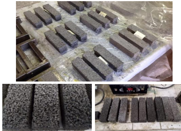
Figura 2: probetas de mortero con APR y FPR como agregado.
