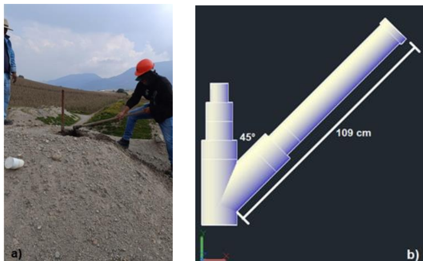
Figura 2. a) Pozo de venteo con derivación de operadores b) Diseño de Derivación Y
