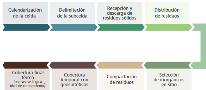
Figura 2. Proceso de disposición final de residuos sólidos en los sitios rehabilitados
