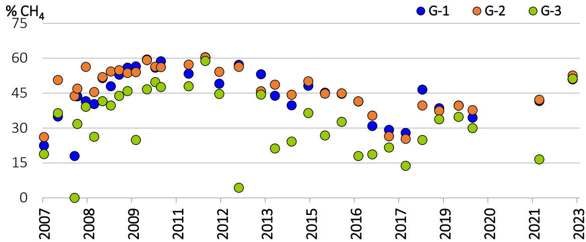
Figura 6. Evolución de la concentración de CH 4 en el biogás del interior del residuo
