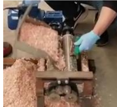
Figura 2. Proceso de molienda de la cáscara en molino de rodillos.
