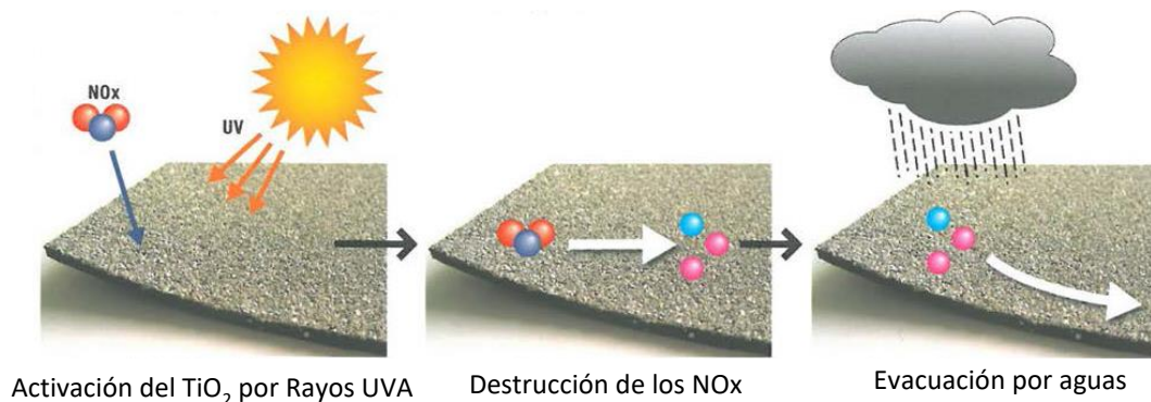
Figura 1. Esquema de funcionamiento de un material fotocatalítico en exteriores. Fuente: Libro Blanco de la fotocatalisis ( https://www.fotocatalisis.org/libro-blanco )
