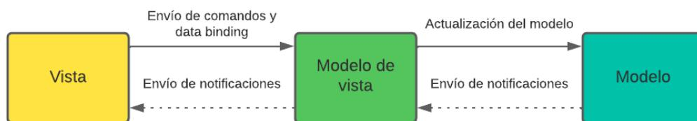
Figura 29: Diagrama de la arquitectura implementada
