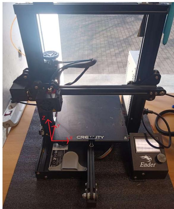
**Figura 13:** Impresora Creality Ender 3 Pro, marcado en rojo su sistema de coordenadas cartesianas.
