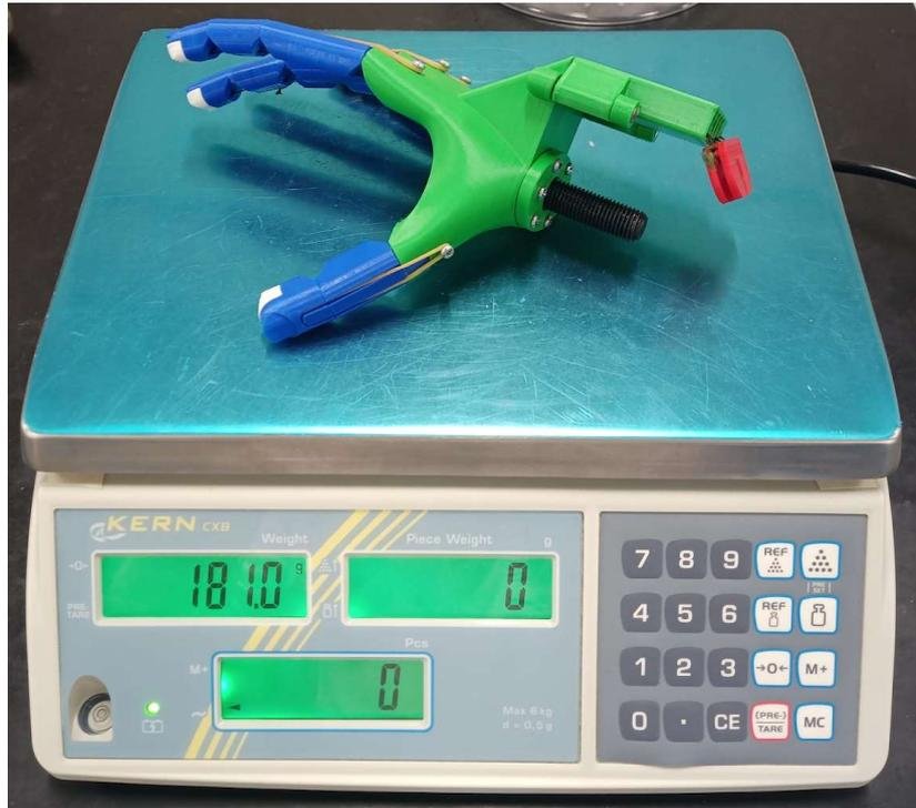
**Figura 61:** Pesaje de la versión final del dispositivo terminal.
