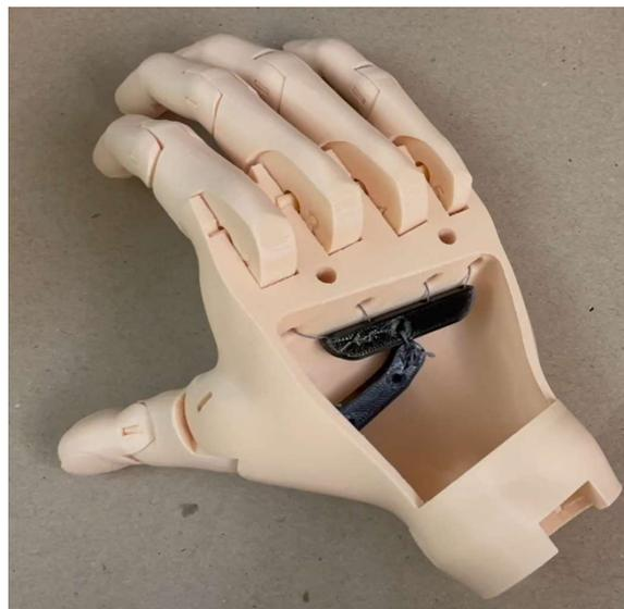
**Figura 8:** Ensamblaje parcial de la mano Kwawu.
