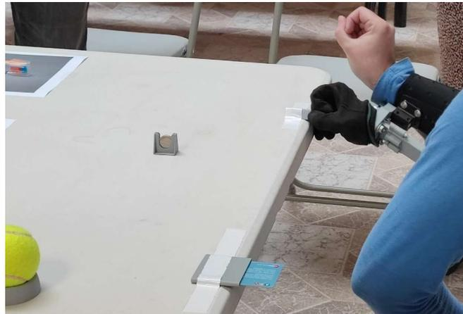
**Figura 71:** Sujeto introduciendo la llave con la prótesis prototipo V2 en en la ranura designada en la segunda prueba del concurso UJI-Hand. Moneda de 1 €, cepillo de dientes, tarjeta y pelota de tenis ya colocados en los lugares designados.
