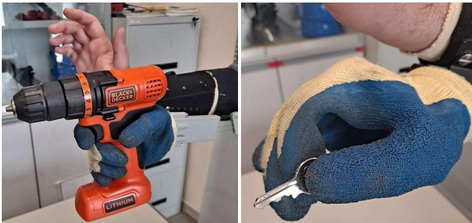
**Figura 66:** Prototipo V2 con guante realizando un agarre cilíndrico sobre un taladro a batería (izquierda). y un agarre tipo pinza lateral sobre una llave (derecha).
