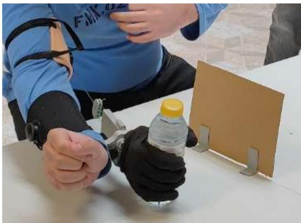
**Figura 69:** Sujeto agarrando una botella de plástico con agua mediante el prototipo V2 para pasarla por encima de la barrera en la primera prueba del concurso UJI-Hand.
