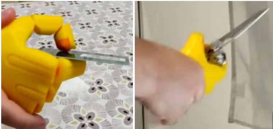
**Figura 45:** Prueba de agarre de una tarjeta mediante el prototipo V1 (izquierda) y de una herramienta multiusos (derecha).
