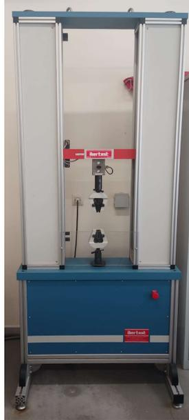
**Figura 13:** Máquina universal para ensayos tracción/compresión IBERTEST ELIB-30/W
