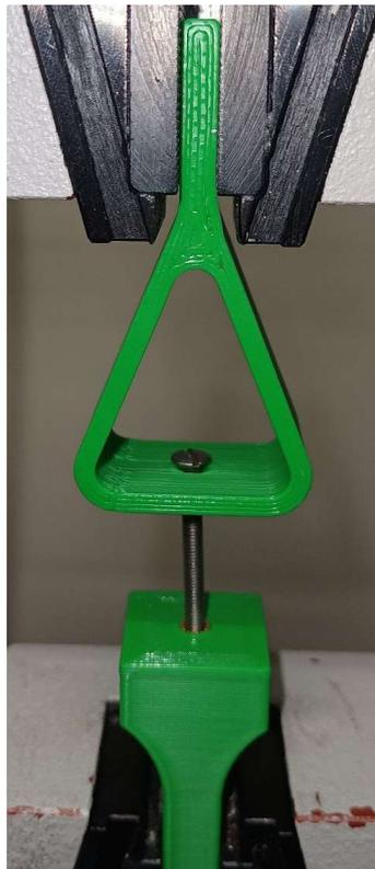
**Figura 2:** Montaje en la máquina de ensayo universal del espécimen para el estudio de la tensión máxima admisible en los insertos roscados, preparado para el ensayo.
