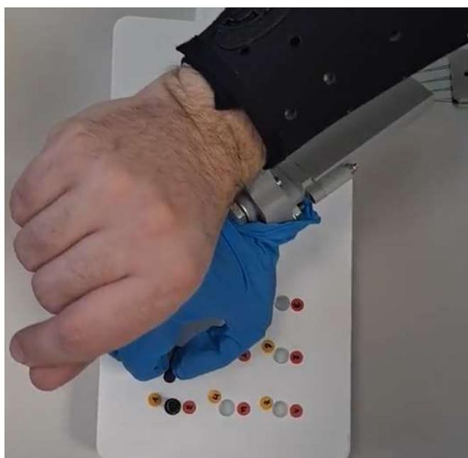
**Figura 67:** Realización del Nine-Hole Peg Test utilizando el prototipo V2.
