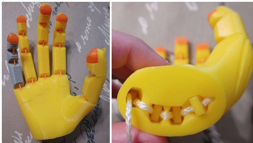
**Figura 44:** Vista frontal del prototipo V1 ensamblado (izquierda), y primer plano del sistema de subactuación (derecha).
