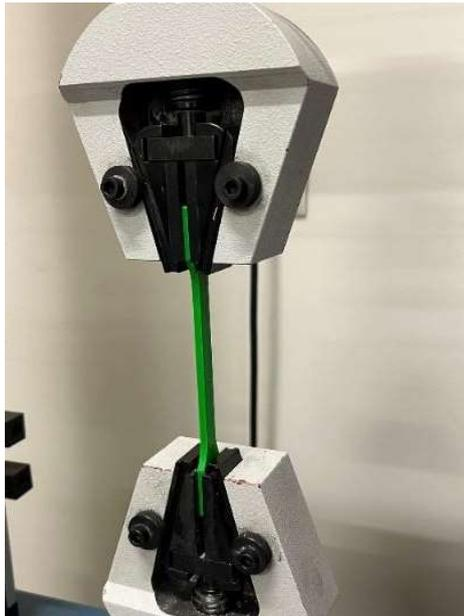
**Figura 29:** Ensayo a tracción de una de las probetas en la máquina de ensayo universal.
