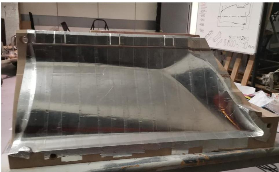
Ilustración 136. Laminación del molde con cinta de aluminio.
