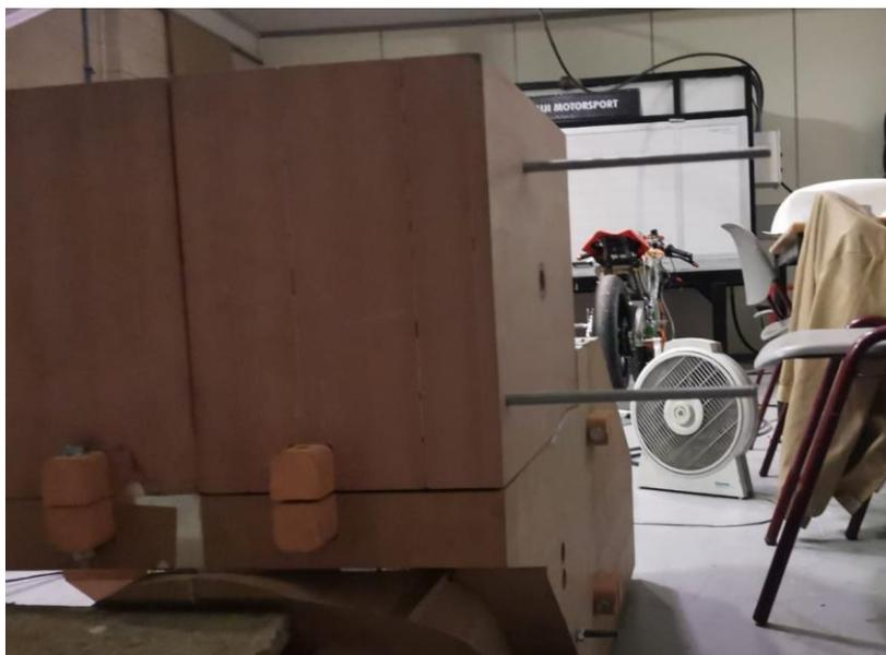
Ilustración 140. Molde Conjunto Frontal, parte delantera.
