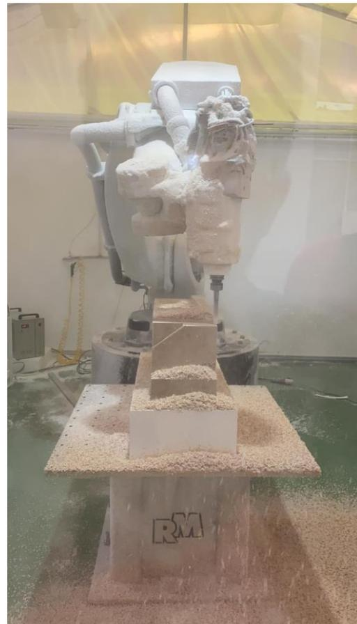
Ilustración 130. Fabricación de moldes mediante mecanizado CNC.
