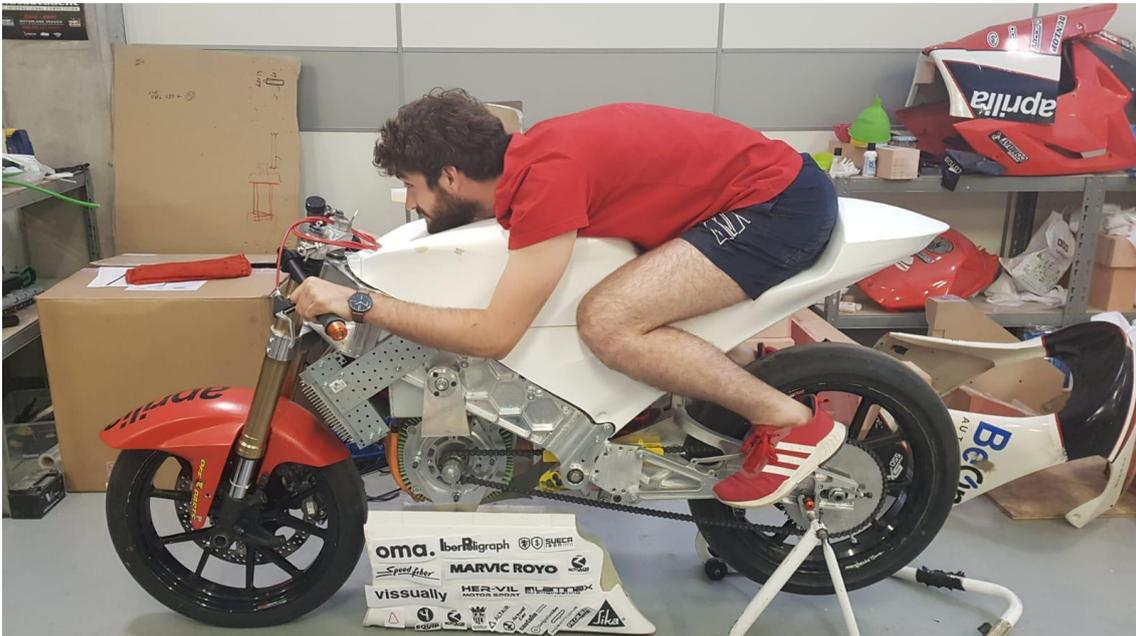
Ilustración 151. Posición aerodinámica con la que se realizara el escáner 3D.
