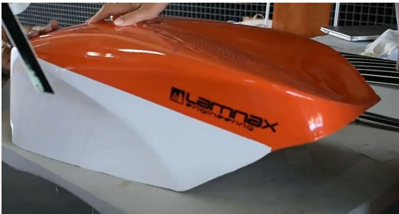
Ilustración 39. Depósito del Carenado fabricado
