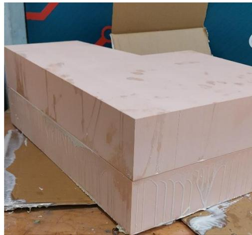
Ilustración 128. Bloques unidos, después de usar el bi-componente.
