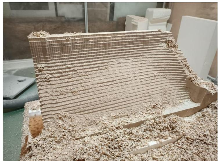
Ilustración 132. Mecanizado de desbaste y mecanizado de acabado.
