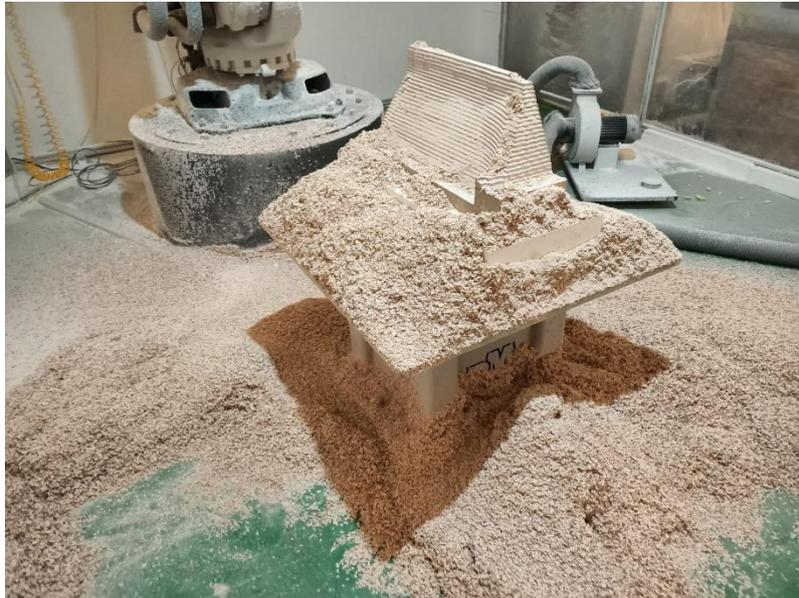
Ilustración 131. Mecanizado molde QL-401, fase de desbaste.
