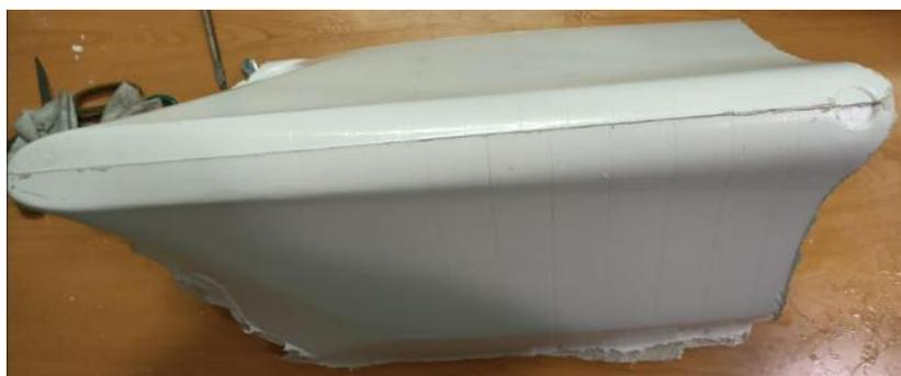
Ilustración 51. Quilla en proceso de fabricación
