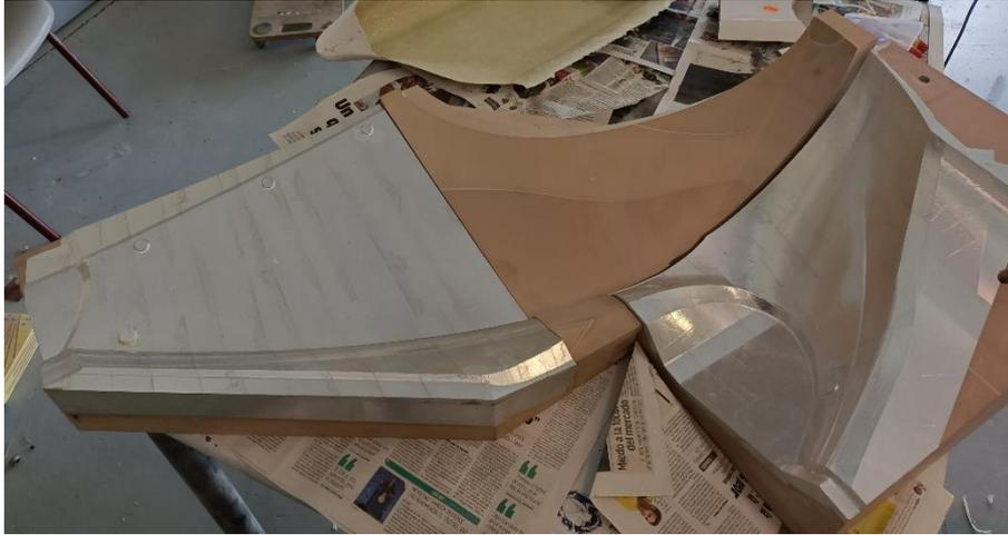
Ilustración 137. Moldes que componen el conjunto derecho del frontal.
