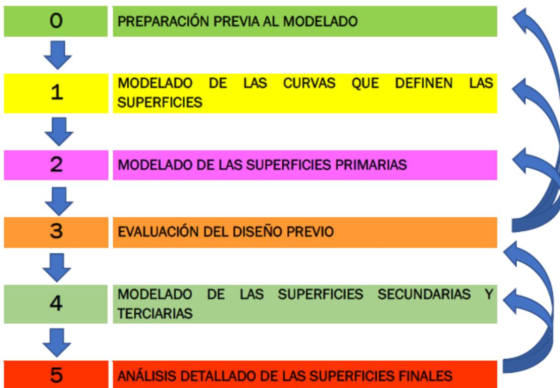
Ilustración 69. Esquema del procedimiento de modelado.
