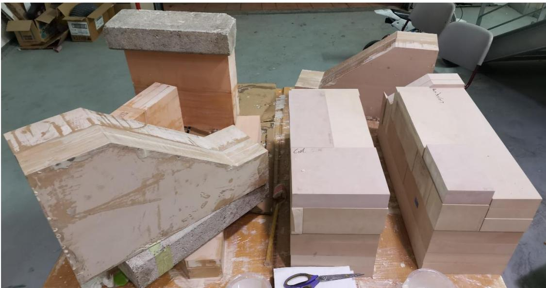
Ilustración 129. Bloques pegados a la izquierda y bloques por unir a la derecha.
