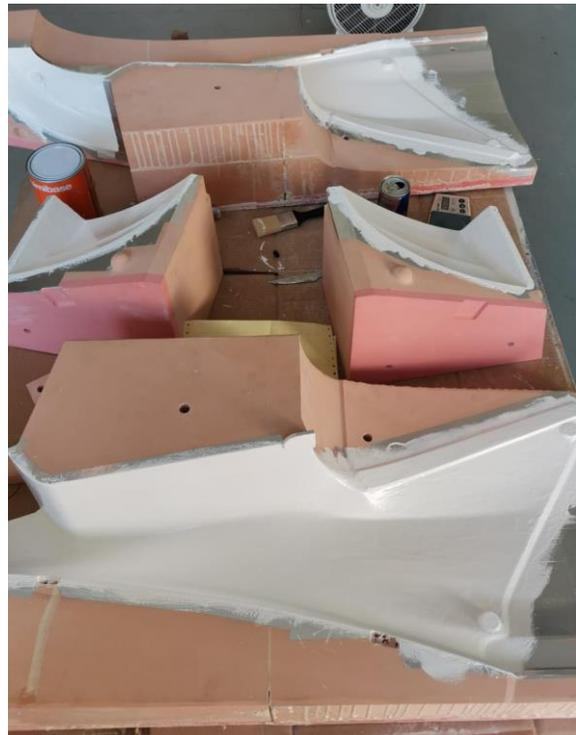
Ilustración 142. Moldes Colín aplicada la capa de Gel Coat.
