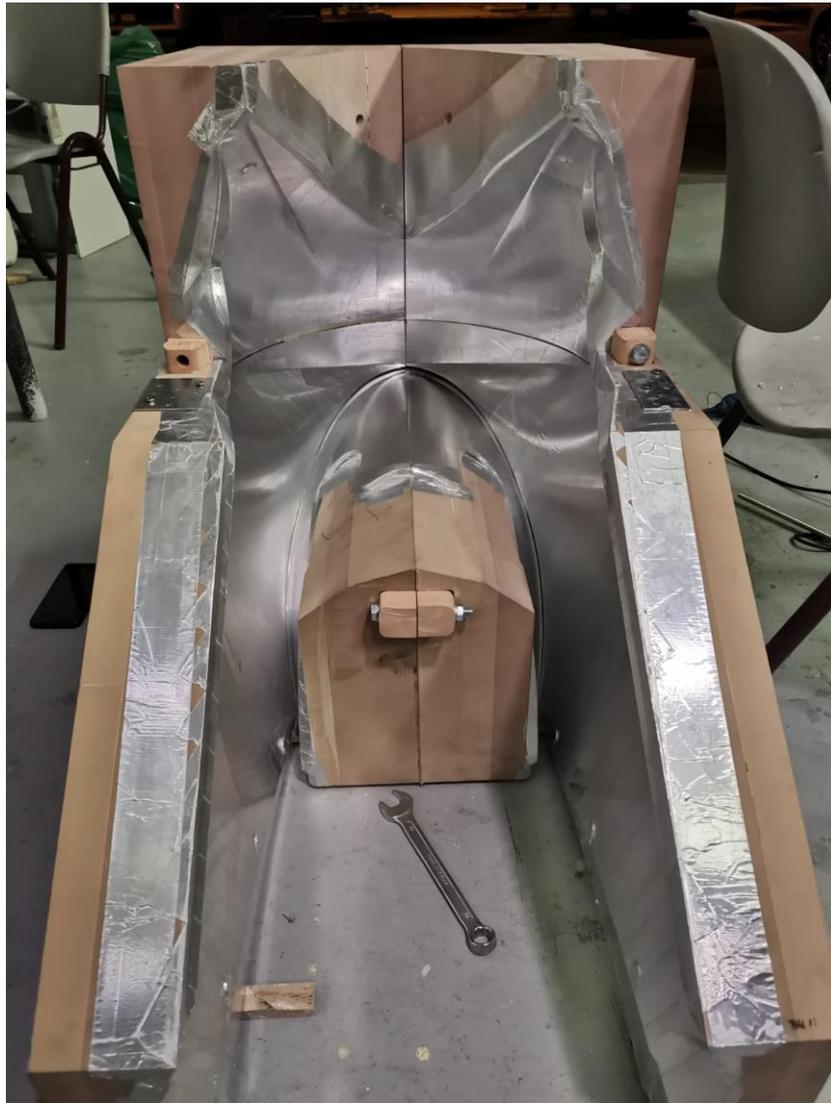
Ilustración 139. Molde Conjunto Frontal, parte trasera.
