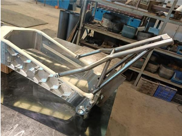
Ilustración 41. Chasis prototipo
