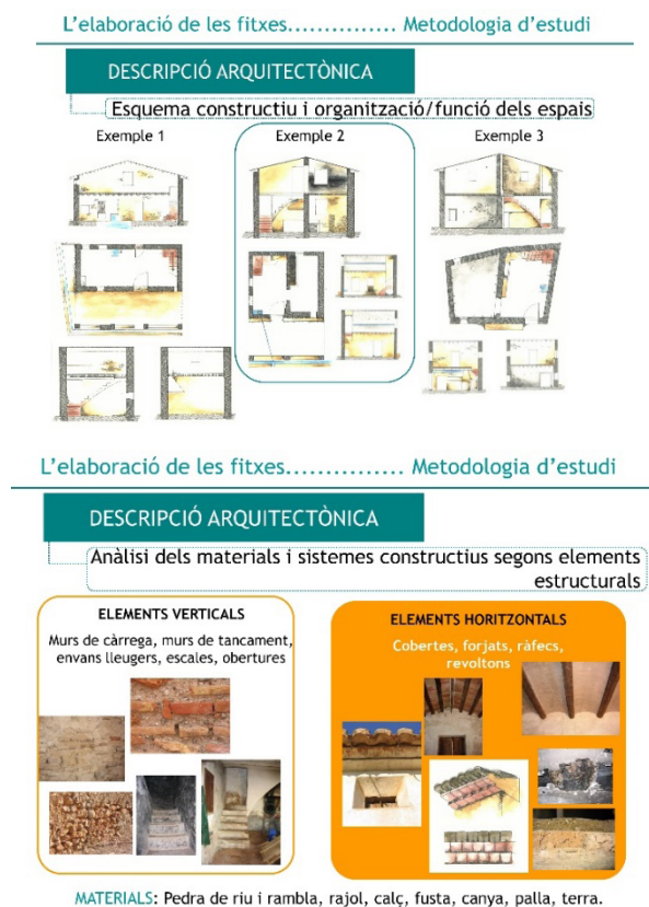
Fig 6. Alçats i crugies. Materials i elements estructurals.
