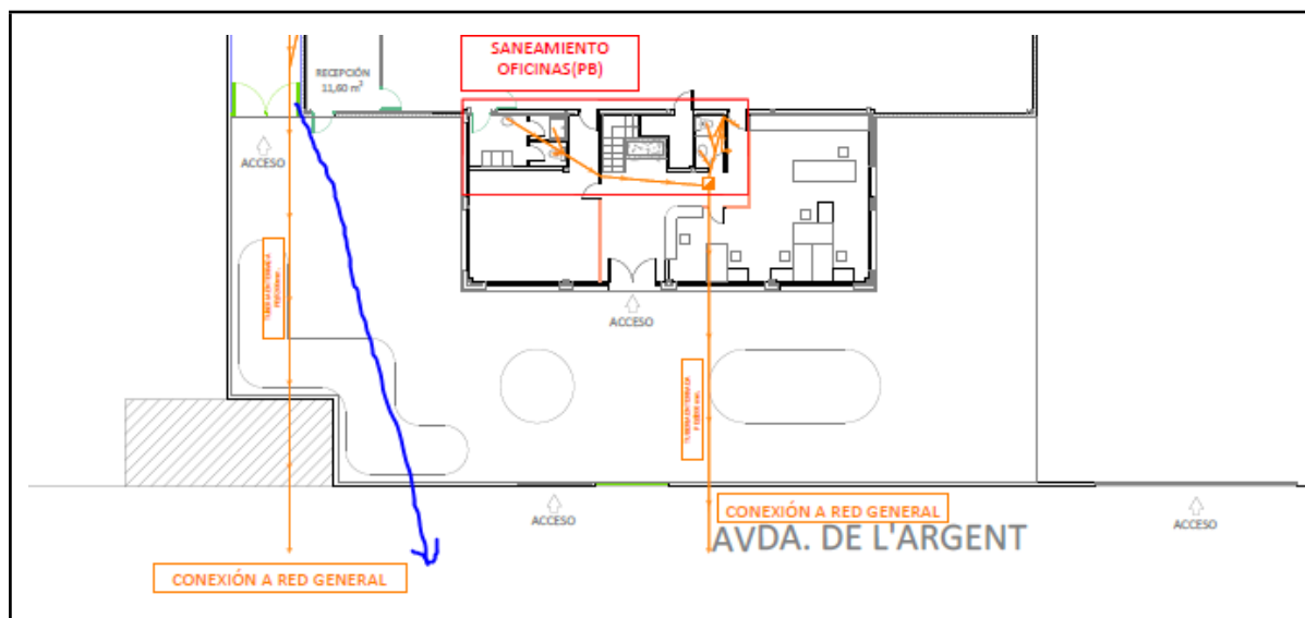
Imagen 14: Desviación de red de evacuación de aguas negras
