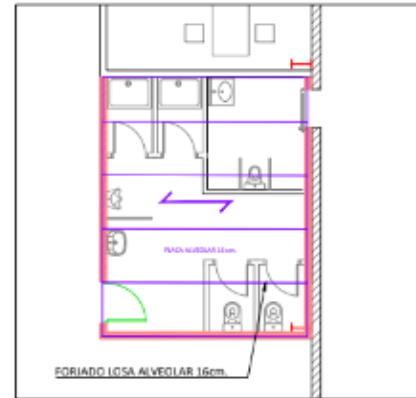
AMPLIACION ASEOS_FORIADO ESCALA 1:100
