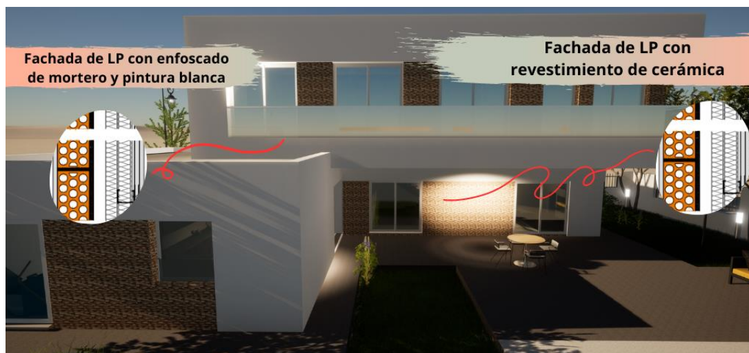
Fig 27. Estado de fachadas después de la modificación.
