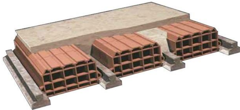
Figura 10. Forjado unidireccional tradicional con bovedilla y vigueta.
