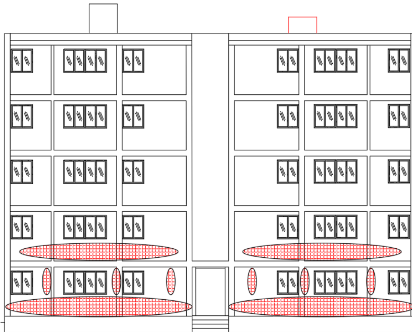
Figura 37. Localización Patología Pérdida Material Revestimiento Fachada Ppal (PM1). Fuente: Elaboración Propia
