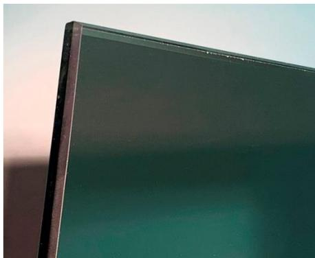
Imagen 4.28 Espejo de espesor 5mm
