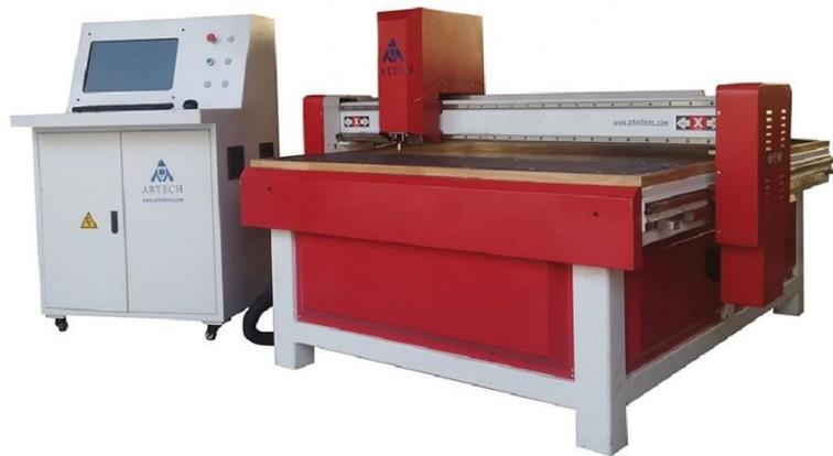
Imagen 4.36 Cortadora de vidrio por CNC Artech 13-13
