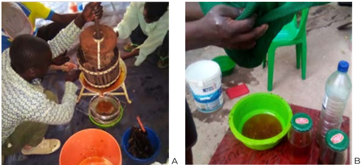
Figura 2. Extractor manual de la miel: (A) prensado con embolo de madera y (B) prensado con mallas porosas
