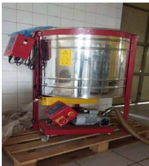
Figura 1. Centrífugas para la extracción de miel: moderna de acero inoxidable (izquierda) y de fabricación artesanal (derecha)
