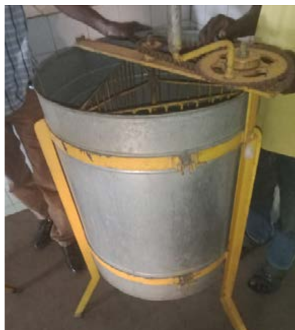
Figura 1. Centrífugas para la extracción de miel: moderna de acero inoxidable (izquierda) y de fabricación artesanal (derecha)
