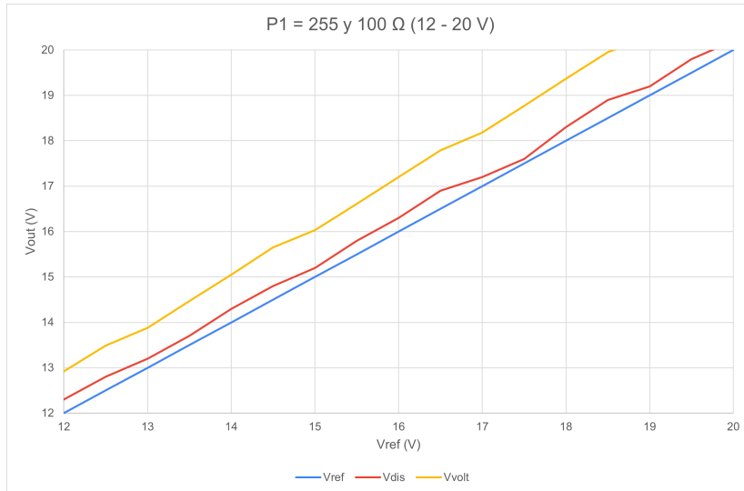
Figura 4.55: P1 = 255 y 100 Ω (12 - 20 V)
