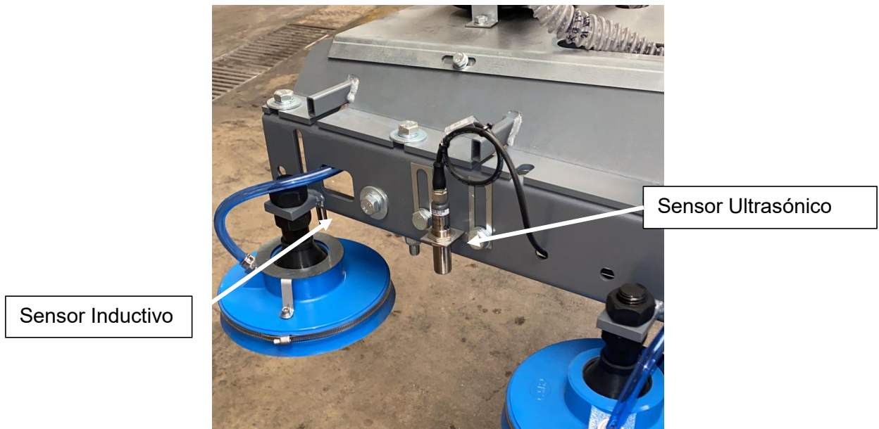
Ilustración 38- Detalle real de sensores utilizados.
