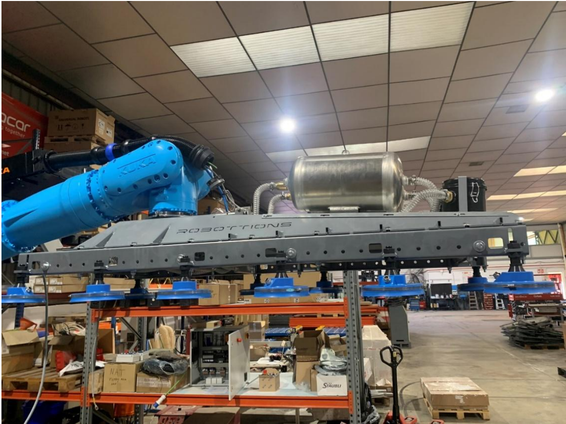
Ilustración 36- Pinza fabricada con elementos de vacío.
