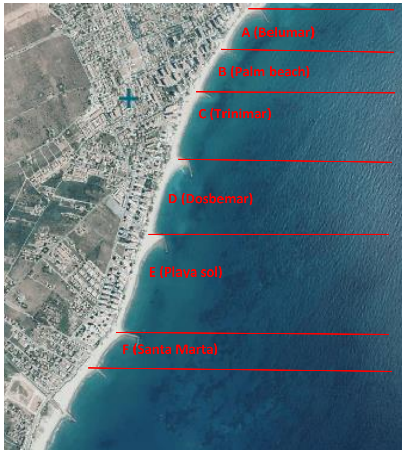
Figura 29. División de la playa del Heliópolis en 6 celdas: A, B, C, D, E y F, correspondientes a los 6 tramos que hay entre los espigones. En paréntesis se indican, los apartamentos, hotel o restaurante, a la altura de los que se han realizado las mediciones
