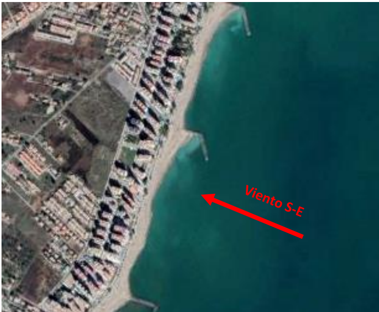
Figura 50. Foto área de las células D y F. El agua rica en sedimentos en suspensión se acumula a barlovento debido a que los espigones obstaculizan su circulación. En este caso concreto, el viento del S-E, típico de la estación estival, acumula el agua turbia en la cara sur de los espigones.
