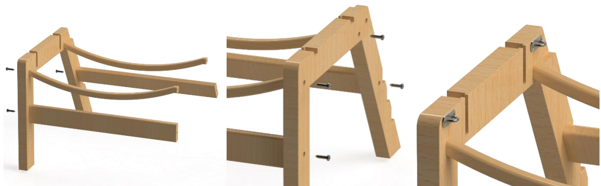
- Figura 86- Montaje estructura asiento
