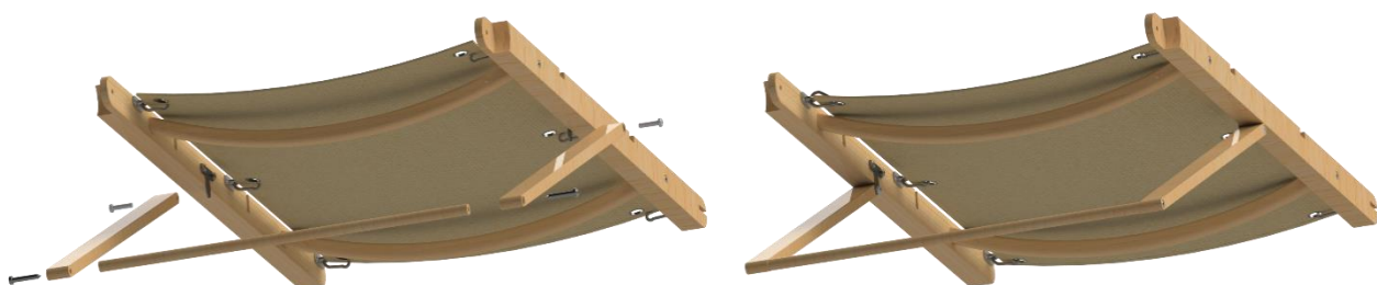
Figura 91- Enganche barras de posiciones respaldo
