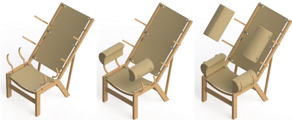
Figura 93- Anclaje abrazaderas y acolchados laterales asiento y respaldo
