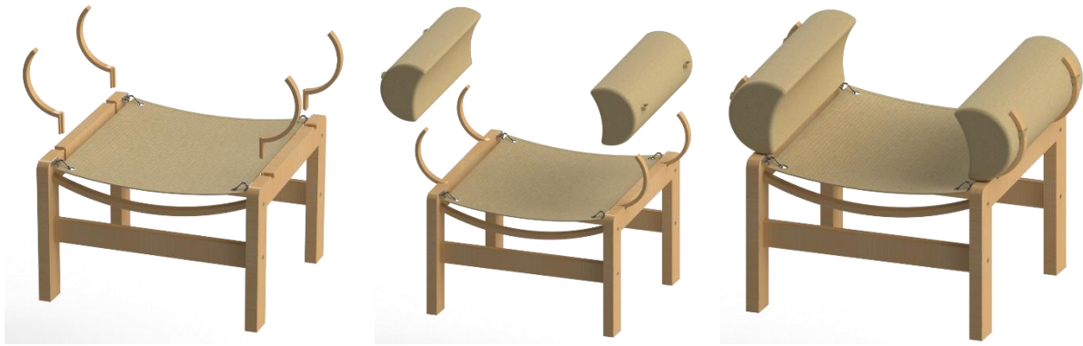
Figura 85- Enganche abrazaderas y acolchados laterales reposapiés
