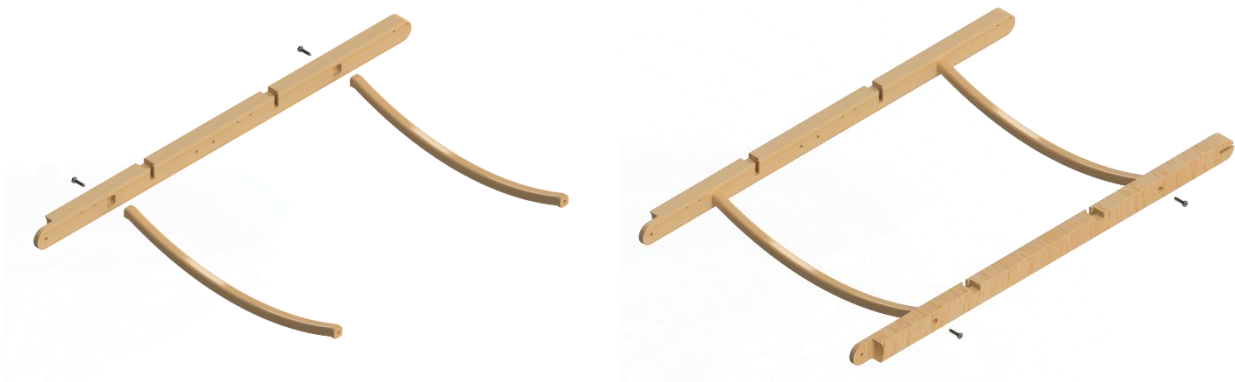
Figura 89- Montaje estructura respaldo
