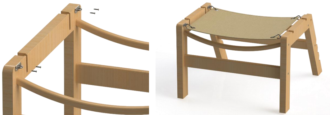
Figura 84- Enganche tela apoyo reposapiés
