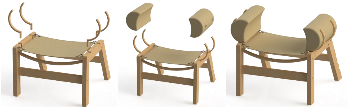
Figura 88- Enganche abrazaderas y acolchados laterales asiento
