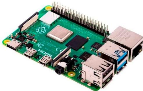
Ilustración 9 Raspberry pi 4 model B 8 Gb
