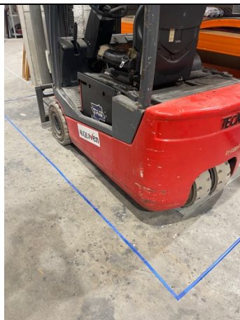
Ilustración 7. Zona de aparcamiento máquina elevadora señalizada.
