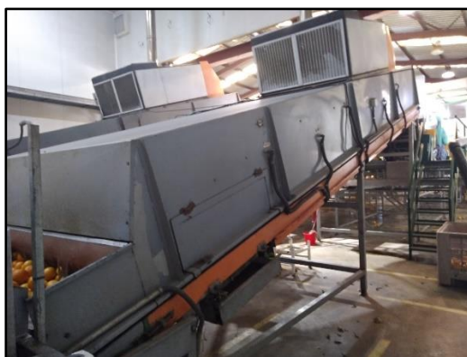
Imagen 9: Imagen del túnel de secado (Imagen de la Cooperativa San Isidro de Benicarló).
