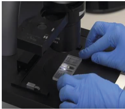
Figura 12. Imagen del enfoque de la cuadrícula de la cámara Neubauer al microscopio.
