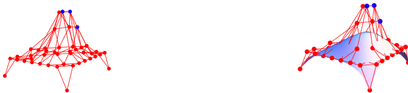
FIGURA 3. A la izquierda vemos que elevamos los puntos, tanto en la frontera como en la fila siguiente. A la derecha vemos la superficie que obtenemos a partir del operador triharmónico para n=8 .
