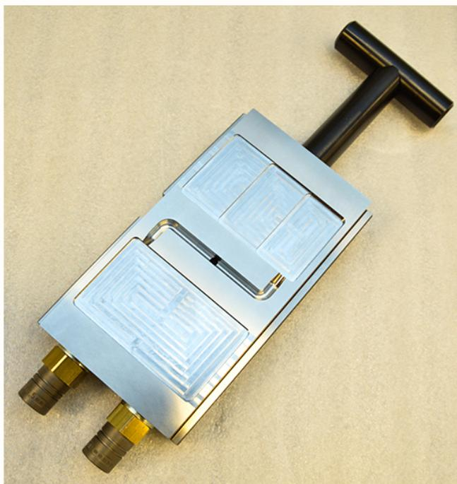
*Imagen 21 M. Alternativa de molde de cambio rápido [17]*
