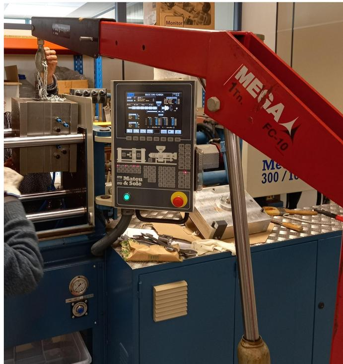
*Imagen 1 M. Proceso de retirar un molde de la inyectora*
