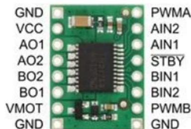
Figura 96. Puertos de un Driver de la marca Pololu [30]
