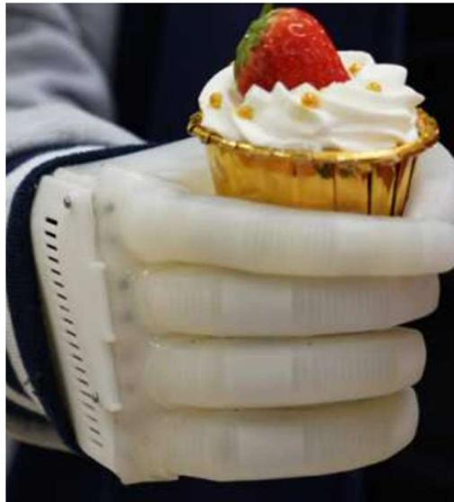
Figura 17. Prótesis neumática del equipo de investigación de Xuanhe Zhao (MIT) [7]
