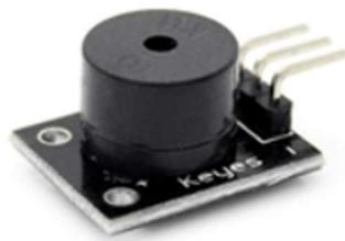
Figura 27. Buzzer de la marca Arduino [14]
